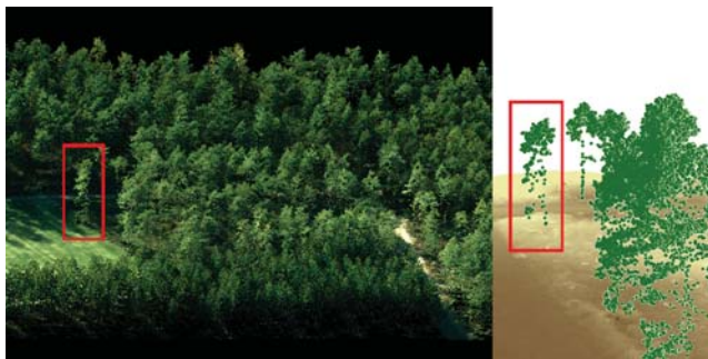
Abb. Links: LiDAR-Punktwolke eines Kiefernforstes bei Lathen/Ems mit überlagerten Farbinformationen des Orthophotos. Abb. Rechts: Ausschnitt aus der LiDAR-Punktwolke auf dem DGM. Die LiDAR-Punktwolke hat eine Lage- und Höhengenaugigkeit unter 1 dm. Quellen: Daten von RWE mit FLIP7 dargestellt, Dipl. Arbeit, C. Knechtel (2010)
